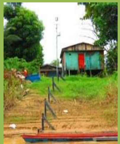
Foto 42 - Ponto de monitoramento hidrológico em margem do rio Acre, em Rio Branco.
